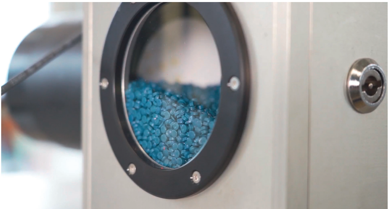
Mit dem Messsystem sind Farbanalysen inline, online und atline möglich. Das erlaubt ein schnelles Eingreifen noch während der Produktion. © SKZ
